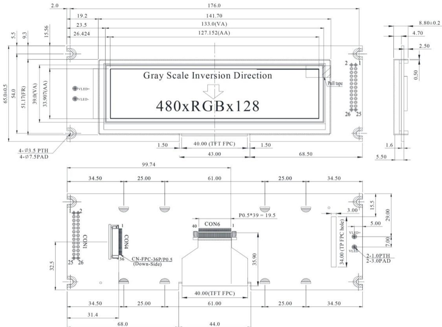
WF52ATLBSDBN0 は 8080 のファミリー MPU の 8 ビット及び 16 ビットパラレルインターフェースをサポートしております。二つ接続するインターフェースオプションがあります。顧客は WG24064A からアップグレードしてほしい場合、CON1 インターフェイスを選択してください。26 ピン 8 ビットにピンヘッダを使用します。顧客は新しいプロジェクトに WF52A を使用してほしい場合は、それが 8080 パラレルインターフェースをサポートしますので、CON4 を選択してください。36 ピン 8 ビット/16 ビットに ZIF コネクタを使用します。詳細についての資料はデータシートに記載しておりますので、担当営業と連絡してください。
